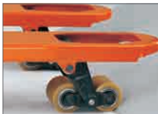
Tandem-Gabelrollen zur Verringerung des Rollwiderstandes auf unebenen Böden und bei schweren Lasten
