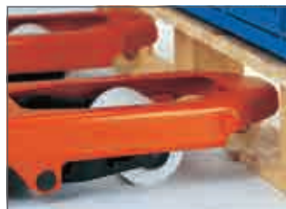
Kletterrollen in den Gabelspitzen für bequeme Einfahrt in quer aufzunehmende Paletten
