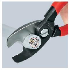
Nachschnitt: Nachdem der Mantel des Kabels im vorderen Profil durchgeschnitten wurde, werden die Leiter im hinteren Profil durchtrennt. Vorschnitt vom, Nachschnitt hinten - so schneidet es sich leichter.
