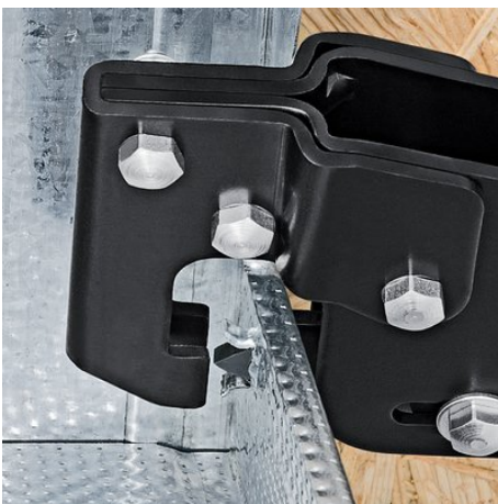
Das Stempelwerkzeug wird durch die Profilbleche gedrückt
