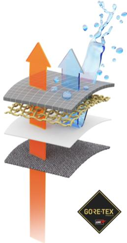
Das GORE-TEX Laminat verhindert, dass Wasser in den Schuh eindringt, lässt die Füße aber dennoch „atmen“. Diese Technologie bietet idealen Klimakomfort bei allen Outdoor-Aktivitäten, auch bei widrigsten Witterungsbedingungen. Sämtliche Komponenten der Schuhkonstruktion sind exakt aufeinander abgestimmt und werden ständigen Qualitätskontrollen unterzogen.
