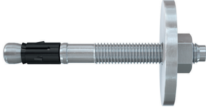
Bolzenanker FAZ II HBS (Scheibe gemäß Holzbaunorm DIN 1052)
