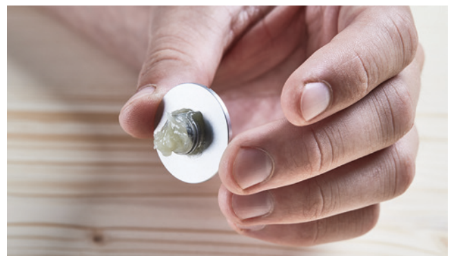
Vor Kontakt mit Klebstoff schraubbare Verbindungen mit Trennmittel Collano HP 2000 einreiben.
