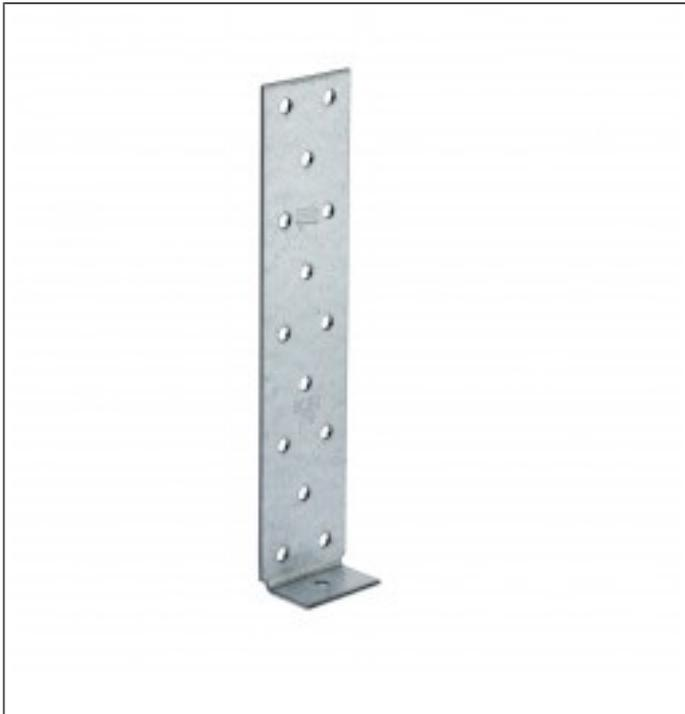
Die BETA Zuganker werden als Zugverbindung von Holzbauteilen an Beton verwendet. Die Anbindung an die Stütze erfolgt mit CNA Kammnägeln oder CSA Schrauben. Der Zuganker muss mindestens 100 mm tief einbetoniert und zur vollen Verankerung um einen Bewehrungsstahl geführt werden.
