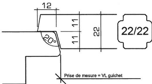
LUX sur aluminium avec fabrication standard Gutknecht
