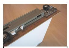
Die Fangmulde vom Soft-Dämpfer 124mm von Türkante entfernt befestigen. Fangmulde muss auf der Seite der Laufrollen sein.
