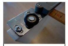
Bei der Vordereren Schraube die Unterlagscheibe mit benützen.
